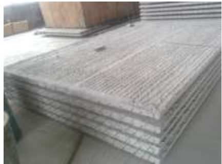
(a) 预应力预制密拼叠合板示意图 (b) 预应力预制底板
